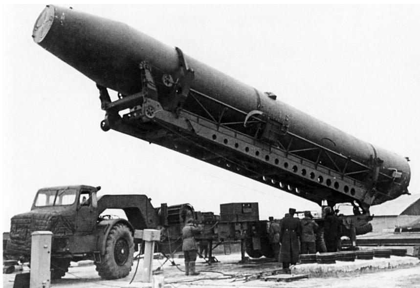
*Загрузка ракеты Р-14У в шахтную пусковую установку.*
